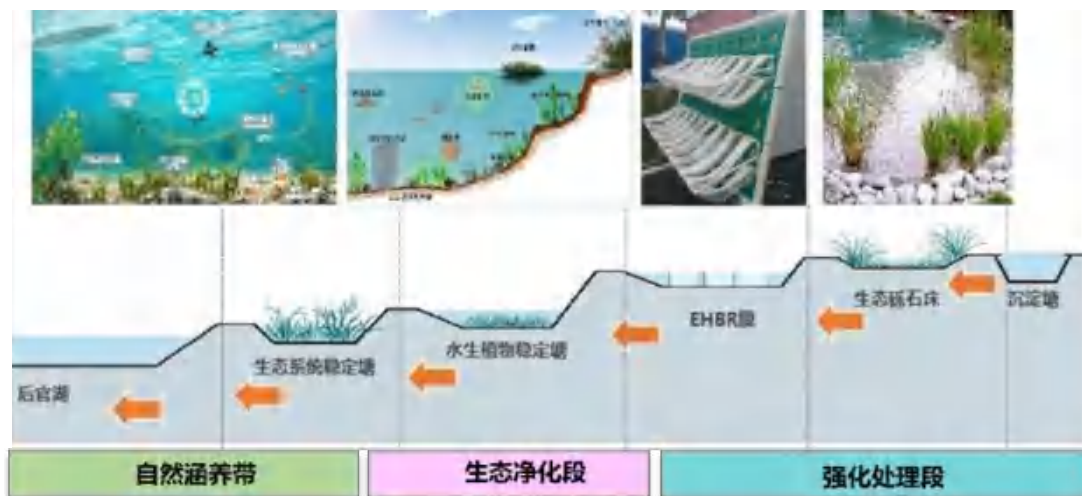
图 63：环湖湿地链净化路径示意图
