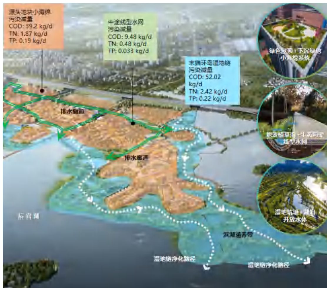
图 68：多级生态截污净化系统示意图
